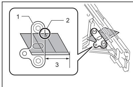
► 1. Portacuchilla 2. Extremo del primer segmento de la cuchilla retráctil desecharable 3. Longitud de corte permitida
