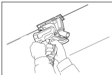
3. Desplace la herramienta en línea recta hasta finalizar el corte.
