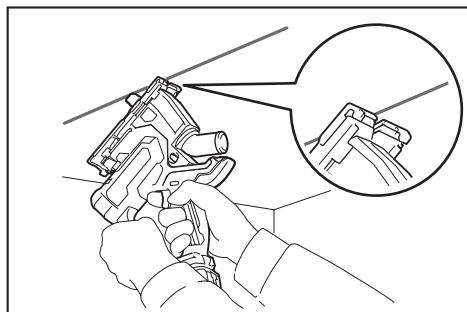
2. Jale lentamente el gatillo sin que la cuchilla haga contacto alguno con la pieza de trabajo. Cuando la cuchilla adquiera plena velocidad, empuje la herramienta hacia la pieza de trabajo. A medida que la cuchilla vaya perforando la pieza de trabajo, haga que toda la superficie de la cubierta de la base haga contacto con la pieza de trabajo.
